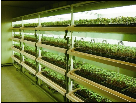
人工光・閉鎖型苗生産装置
